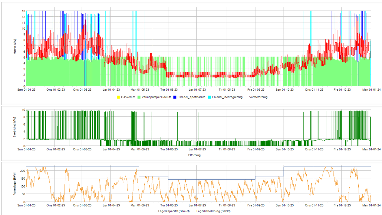
Figur 4: Øverst energiproduktionen fordelt på forsyningsarter. I midten el-effekten og nederst udnyttelse af VAK-tanken
